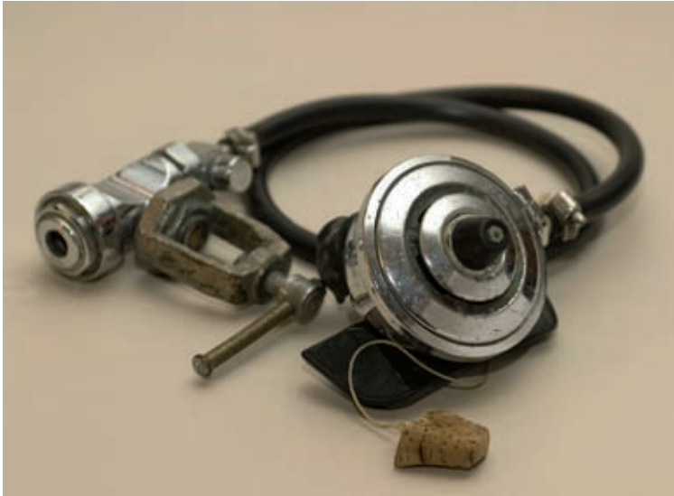
N.22 EROGATORI AQUILON - LA SPIROTECHNIQUE utilizzati da Raimondo Bucher . Notare la modifica fatta sul pulsante di erogazione del secondo stadio ( Museo Nazionale delle Attività Subacquee ).
