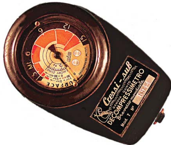
Decompressimetro DCP in kralastic. L'esemplare della foto è di fine anni '60, diverso solo in qualche piccolo particolare dal primo modello presentato dalla SOS di Torino nel 1959
