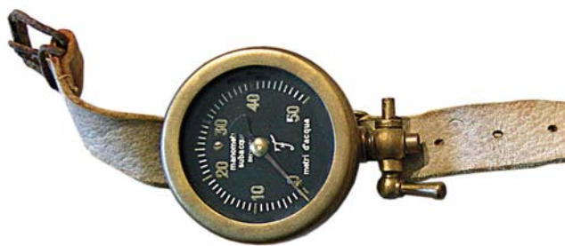
Profondimetro Fortuna di fine anni '50, caratterizzato dal manettino col quale si poteva bloccare la lancetta sulla profondità massima raggiunta
