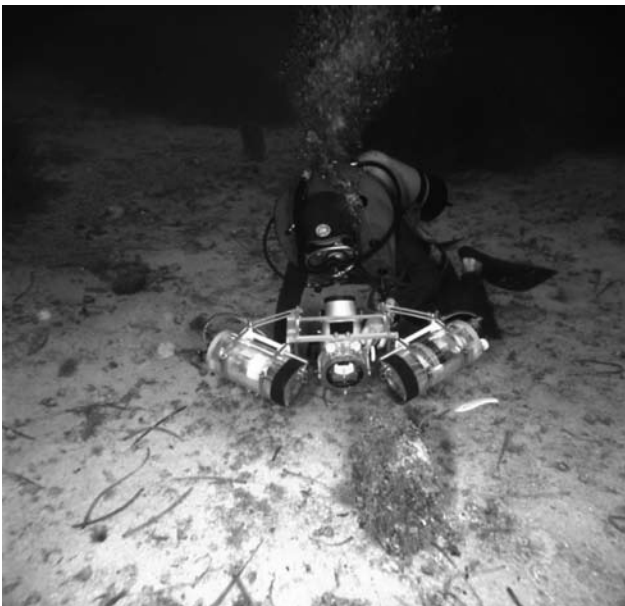
L'Hasselblad scafandrata da Piero Solaini con due flashes elettronici
