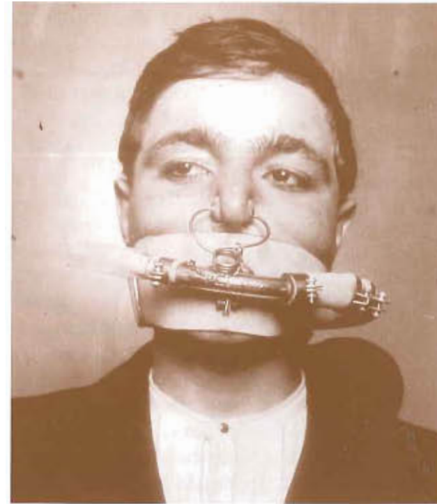
Fig. 4 - Particolare del boccaglio Fernez con a destra l'attacco della manichetta di alimentazione aria ed a sinistra la valvola di scarico a "becco d'anatra"
