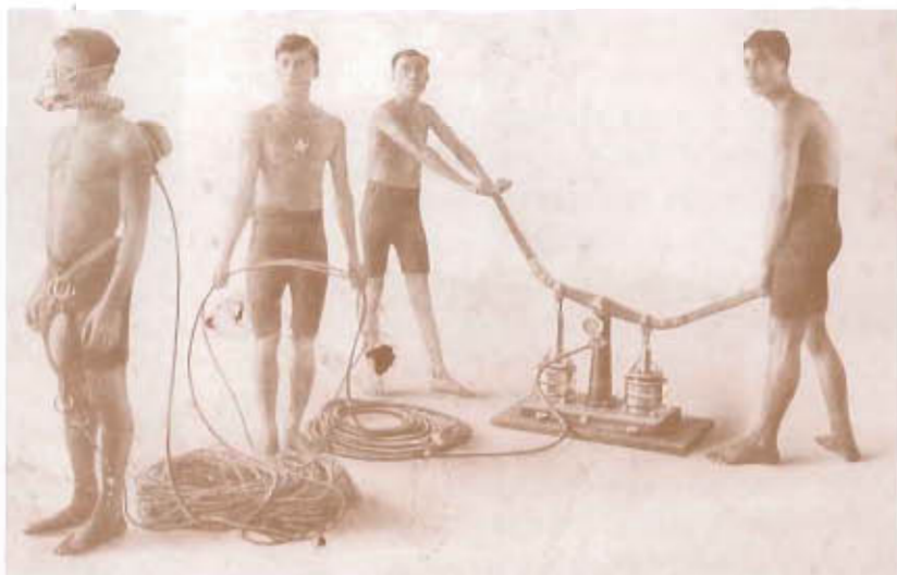
Fig. 7 - Apparecchio "Fernez 2" per immersioni a grande profondità. La pompa aria per automobili è stata sostituita da una doppia pompa a brandeggio
