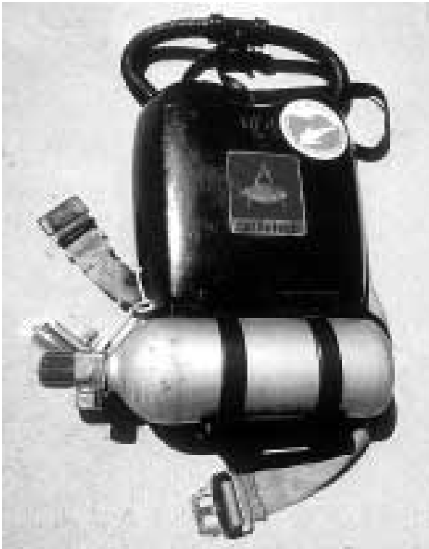
Fig. 17 - "ARO amagnetic" ciclico della Technisub, degli anni 1970, dotato di scudo protettivo incernierato, possibilità di fornire l'ossigeno manualmente od in automatico. E' stato l'unico ARO prodotto da questa ditta. (per g.c. Giovanni Magnani)
