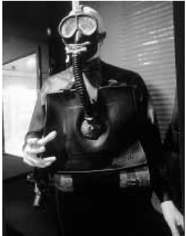
Fig. 16 – Il “Super ARO” della Cressi per la MMI, con bombola amagnetica datata 1988. Da notare che ancora a quella data l’ARO militare era privo della “peretta” per la raccolta di condensa, saliva e piccole infiltrazioni d’acqua (Museo Nazionale delle Attività Subacquee).
