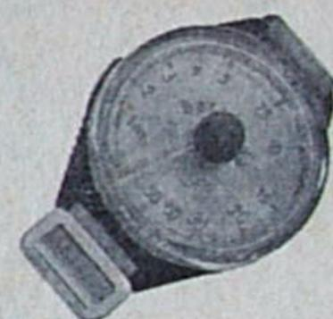
Der **BARAKUDA-TIEFENANZEIGER** zeigt die Wassertiefe mit Hilfe einer Boyle-Mariott'schen Röhre an (Ablesung ähnlich wie bei einer Thermometer-Skala). Das Volumen der Meßkanüle ist mit Hilfe eines Stöpsels regulierbar.
