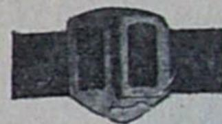
Schnellabwurfvorrichtung mit selbsthemmender Zugverstellung.
